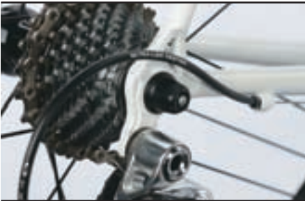
Stahlschaltaugen kann man zurückbiegen.
