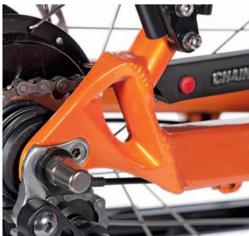
**Materialgerecht:** Treppenförmig hat Hilite das Sitzstreben-Schloss gestaltet. Die Schraubengewinde sind oberflächenbündig abgeschliffen.
