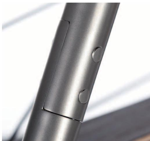
**Spannend:** An Langlöchern fixiert Norwid verschiebbare Rohloff-Ausfallenden. Stellschrauben fixieren die passende Einstellung der Kettenspannung.
