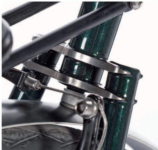
**Plattenbau:** Zwei beschliffene, seitlich offene Platten verlötet Bendixen zwischen Monostay und Sitzstreben. Das Gegenstück befindet sich am Gabelkopf.
