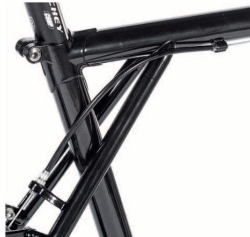
**Triangel:** Die verlängerten Sitzstreben bilden zum Oberrohr hin eine stabilisierende, zusätzliche Abstützung des Hinterbaus.
