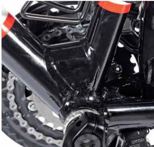
**Verstärkung:** Eingeschweißte Gussets stabilisieren Unter- und Sitzrohr am Juchem.
